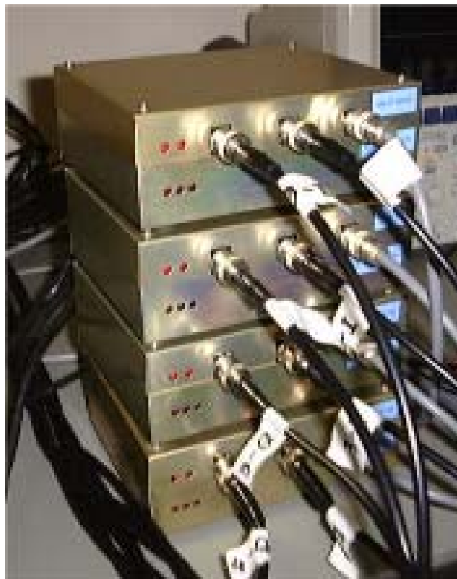
図 2-9 : A/D ボードを 4 つ接続した概観
