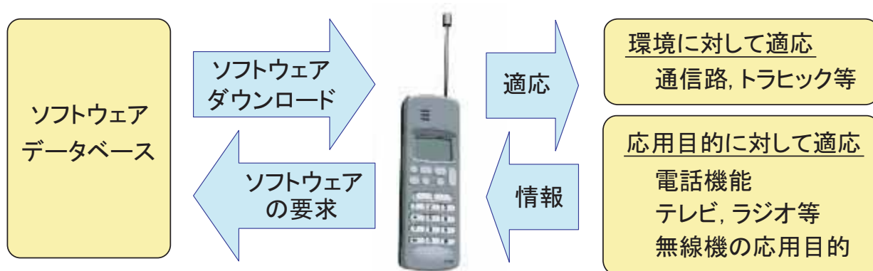
図 1.1: ソフトウェアによる無線機の再構成
