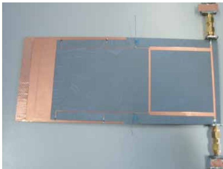
図 3.17: 擬似伝送リアクタンスを追加したハイブリッド型移相器回路
