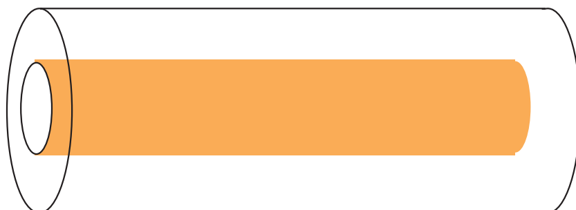
図 3.1: 同軸線路のモデル
